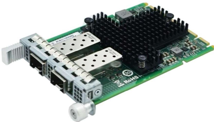
LRES3012PF-OCP 是深圳市联瑞电子有限公司在基于 Intel 主控方案基础上自主研发的一款 PCI Express v2.0 x8 OCP 3.0 万兆双口光纤以太网网络适配卡，采用的物理板尺寸符合 OCP 3.0 设计规范、小尺寸 ( SFF ) 面板。该适配卡通过为服务器和网络虚拟化技术提供的特性来满足下一代数据中心的需求。在灵活的局域网和 SAN 网络中提供可靠的性能。该适配卡在一个 PCI Express v2.0 SFF 结构上具有灵活的双口 10GbE 的链接速率。
