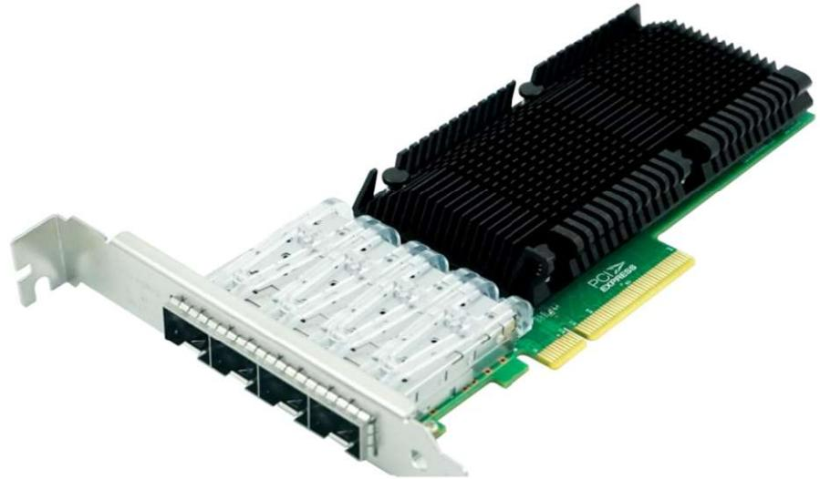
LRES1005PF-4SFP+ 是深圳市联瑞电子有限公司在 Qlogic QL41xxxx 方案基础上开发的一款 PCI Express v3.0 x8 四光口 10G 以太网网络适配器。该适配器专为大容量融合网络的大数据传输应用而设计，可以同时向下兼容 PCIe v2.1/v2.0/v1.1。该适配器在一个 PCI Express v3.0 x8 插槽上能实现四口全双工吞吐量达 80GB 的传输速率。
